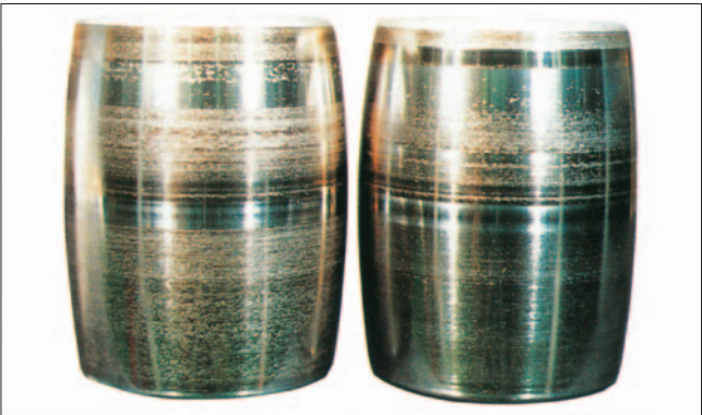
Часть: Выпуклые ролики сферического роликоподшипника Признак: Размывание происходит в центре поверхности качения Причина: Неправильная смазка
