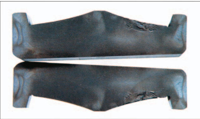
Часть: Поперечное сечение сломанного внутреннего кольца сферического роликоподшипника Признак: Источник находится непосредственно под поверхностью дорожки качения
