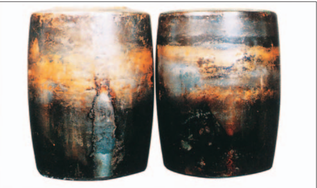
Часть: Выпуклые ролики сферического роликоподшипника Признак: Обесцвечивание и плавление поверхности качения ролика, прилипание частиц стирания сепаратора Причина: Недостаточная смазка
