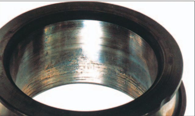
Часть: Внутреннее кольцо сферического роликоподшипника Признак: Проскальзывание сопровождающееся задирами поверхности отверстия Причина: Незначительная интерференция
