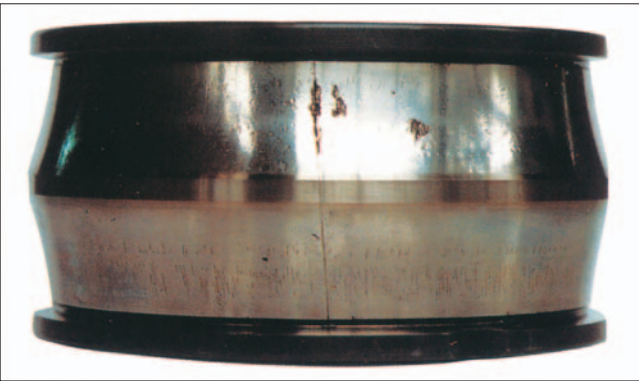
Часть: Внутреннее кольцо сферического роликоподшипника Признак: Осевые трещины возникают на поверхности дорожки качения Причина: Большое давление на фиттинги из-за разницы температур вала и внутреннего кольца
