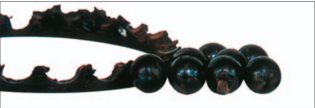
Часть: Шарики и сепаратор радиально-упорного шарикоподшипника Признак: Сепаратор поврежден плавлением; шарики обесцвечены и оплавлены Причина: Чрезмерная предварительная нагрузка
