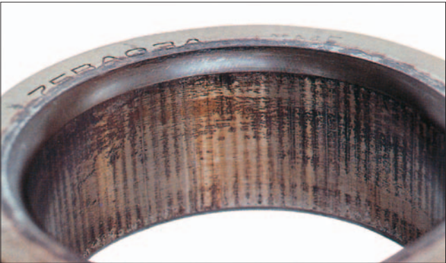
Часть: Внутреннее кольцо радиально-упорного шарикоподшипника Признак: Заметное коррозийное истирание происходит по всей окружности поверхности отверстия Причина: Недостаточная посадка с натягом
